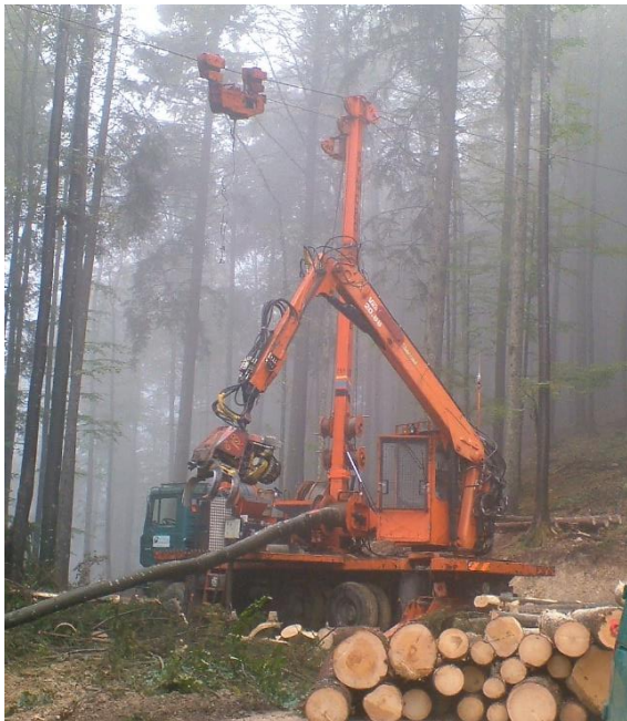
Maszyna – kolejka linowa do wycinania, okrzyszowania, przycinania i wyciągania drewna na stokach górskich - Alpy Bawarskie.
